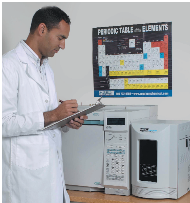
Un generatore d'aria zero che alimenta un gascromatografo
